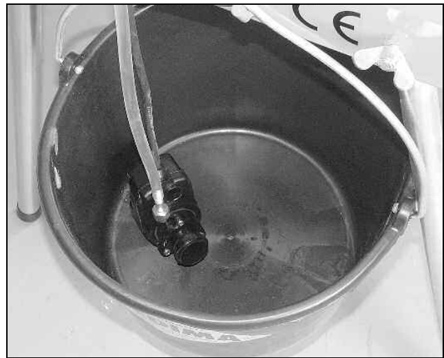
Рис. 3.8 Водяной насос погружен в ведро
