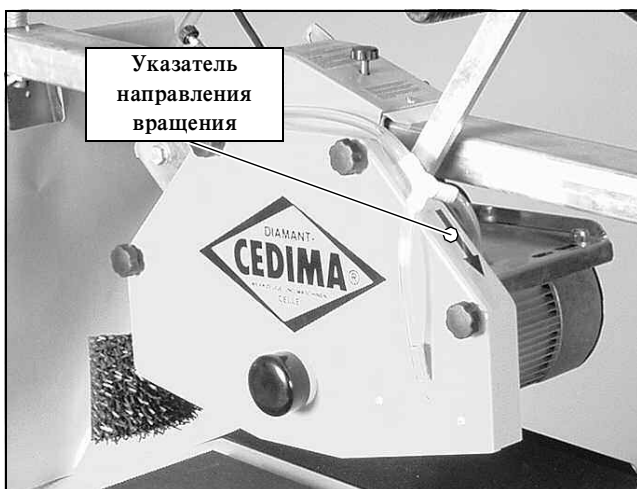
Рис. 3.13 Указатель направления вращения на защитном кожухе
