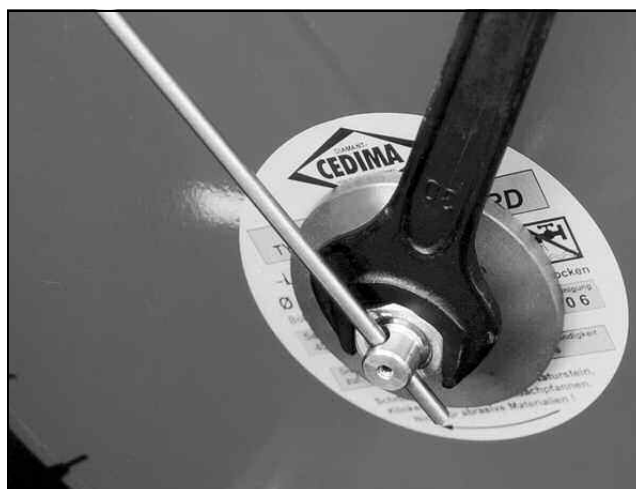
Рис. 3.15 Закрепление диска с помощью прошивки и гаечного ключа
