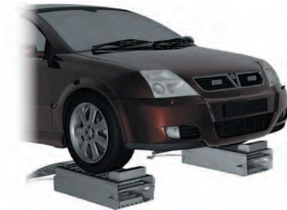
Рисунок 5 – Установка автомобиля на эстакады
