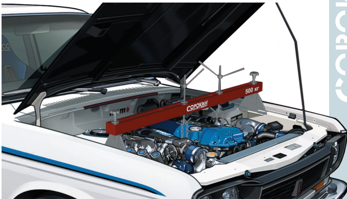
Рисунок 3 – Установка держателя в моторном отсеке
